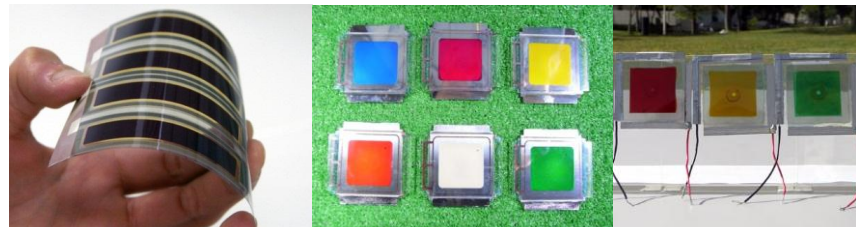
フレキシブル・カラフル・シースルー (産学連携応用開発研究) 軽量・安価な太陽電池
